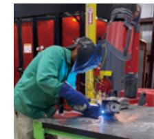
響を確認しました。従業員は空気品質モニターを装着して作業し、溶接ヒュームのサンプルを採取。これをもとに適切な換気設備設置のほか、安全具使用と適切な作業手順の重要性を再確認しました。
